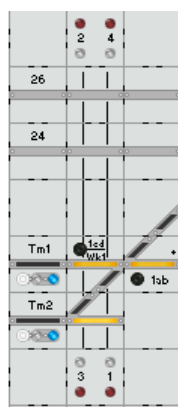
Rys. 3.2. Lampki kontrolne urządzeń przejazdowych (przebieg utwierdzony, rogatki zamknięte i utwierdzone)
