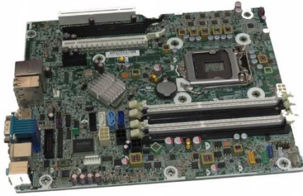
Obrazek 2: Płyta główna w diagnozowanym komputerze
